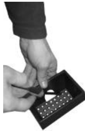
Fig. 35 - Rengöring av brännkoppen
