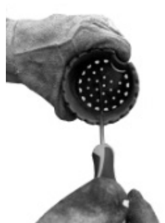
Fig. 35 - Rengöring av brännkoppn
