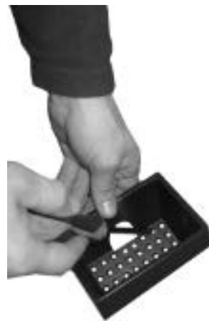
Fig. 35 - Rengöring av brännkopp
