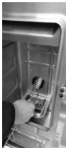
Fig. 36 - Rengöring med piprensare
