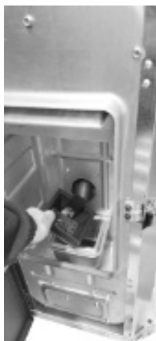
Fig. 33 - Borttagning av brännkoppen
