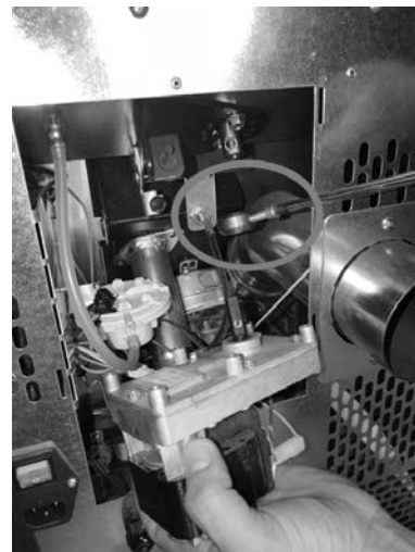
Fig. 43 - Borttagning av växelmotor
