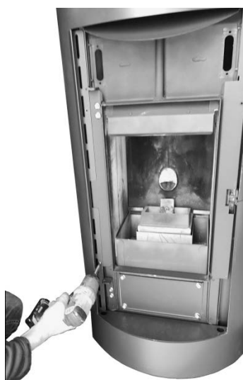
Fig. 19 - Borttagning av profilskravar (höger och vänster)
