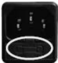
Fig. 46 - Lucka med säkringar som ska tas bort
