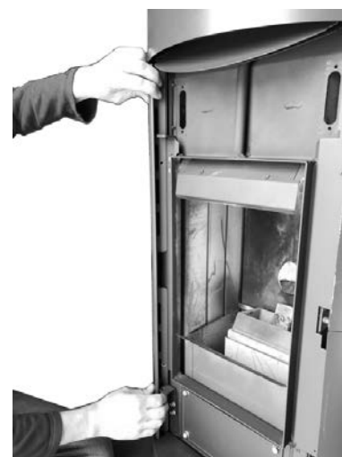
Fig. 20 - Borttagning av främre profiler (höger och vänster).
