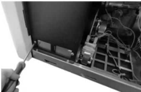
Fig. 87 - Rengöring av rumsfläkt
