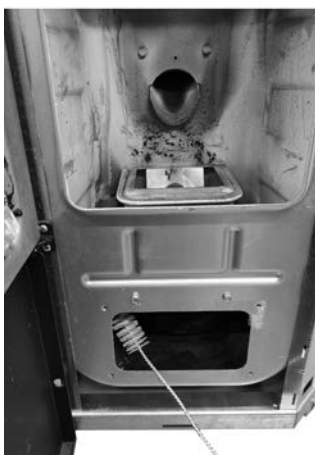
Fig. 70 - Rengör med en rörrengöringsborste
