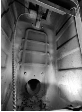
Fig. 72 - Rengör med en rörrengöringsborste
