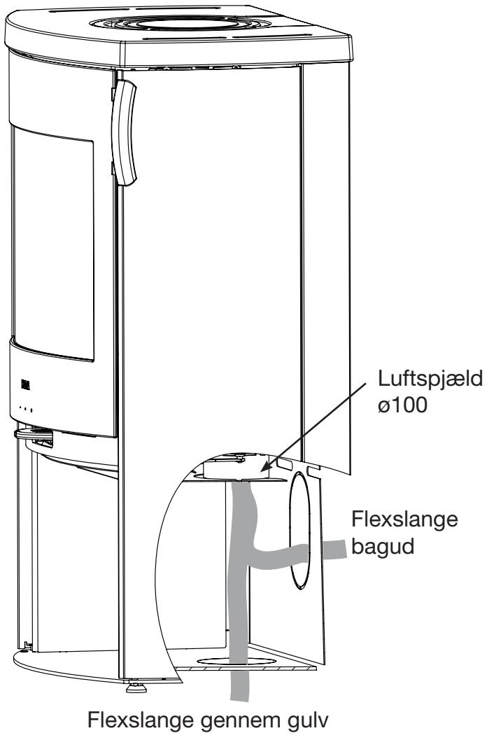
Ved montering af ekstern lufttilførsel kan der føres en flexslange fra luftregulering til luftudgang bag ovnen.
