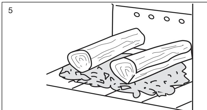
Nomiel ydelse på 7,1 kW er svarende til en fyringsinterval på ca. 51 minutter ved:
